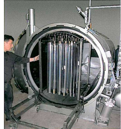
Autoclave diametro 1600, lunghezza 3500 mm, pressione 8 bar, temperatura 200 C°, estrazione del carrello dopo il ciclo. Autoclave diameter 1600, line length 3500 mm, pressure 8 bar, temperature 200 C°, trolley exit after cycle.
