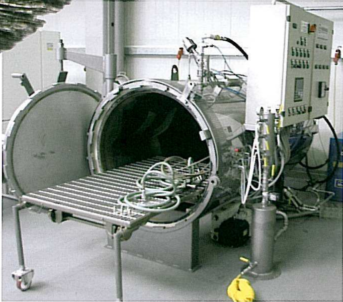
Autoclave diametro 1250 mm, lunghezza 2500 mm, pressione 15 bar, temperatura 300 C°, con compressore / essiccatore silenzioso, carrello con derivazioni vuoto e ruote mobili. Autoclave diameter 1250 mm, line length 2500 mm, pressure 15 bar, temperature 300 C°, equipped with noiseless air dryer/compressor, trolley with vacuum joints and movable wheels.
