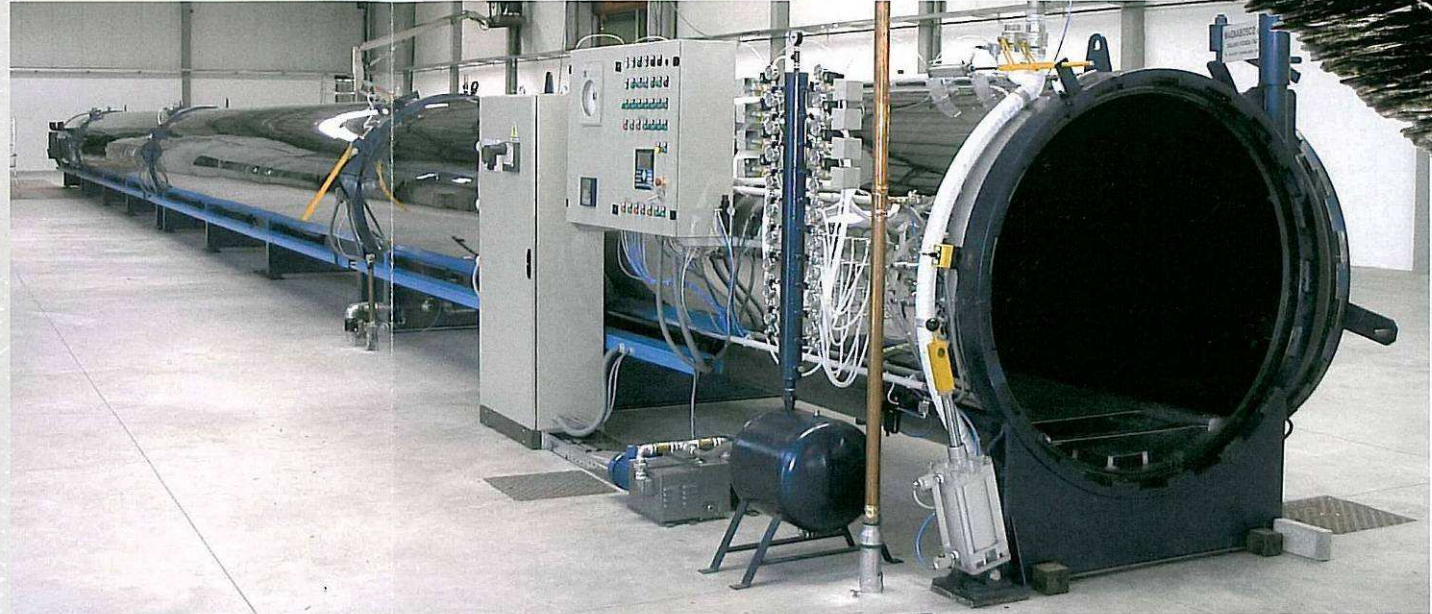
Autoclave diametro 1500 mm, lunghezza 40 metri, pressione 10 bar, temperatura 200 C°, con 30 punti vuoto, 30 termocoppie, controllo automatico del vuoto, riscaldamento modulare, motore con inverter
