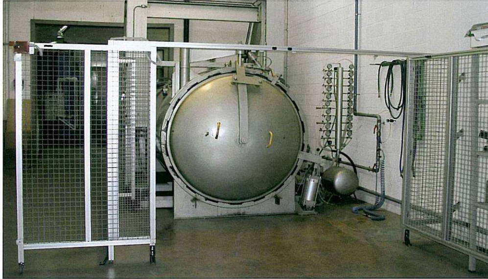
Autoclave diametro 1600 mm, lunghezza 4000 mm, pressione 10 bar, temperatura 250 C° in posizione orizzontale per il carico e lo scarico del materiale Autoclave diameter 1600 mm, line length 4000 mm, pressure 10 bar, temperature 250 C° in horizontal position for product loading/unloading.
