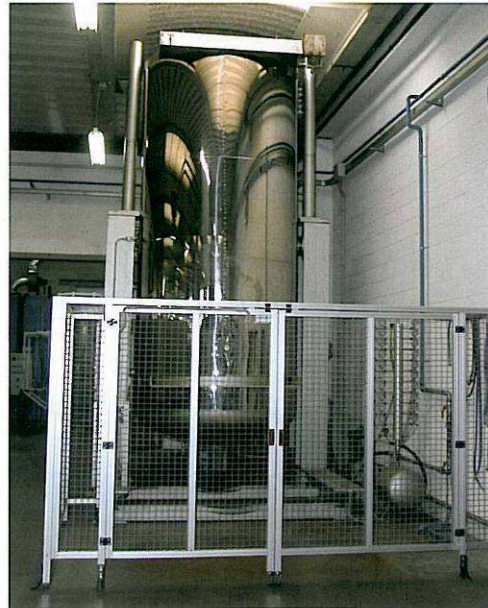
Autoclave in posizione verticale, in questa posizione inizia il ciclo di polimerizzazione Autoclave in vertical position, in this position the polymerisation cycle starts.
