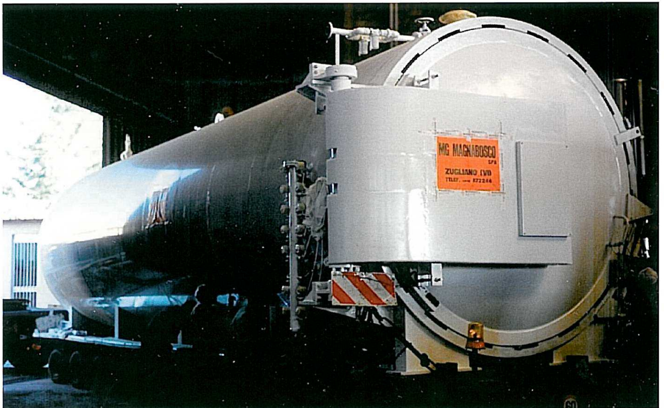
Autoclave diametro 3500 mm, lunghezza 15.000 mm, pressione 12 bar, temperatura 300 C° Autoclave diameter 3500 mm, line length 15.000 mm, pressure 12 bar, temperature 300 C°
